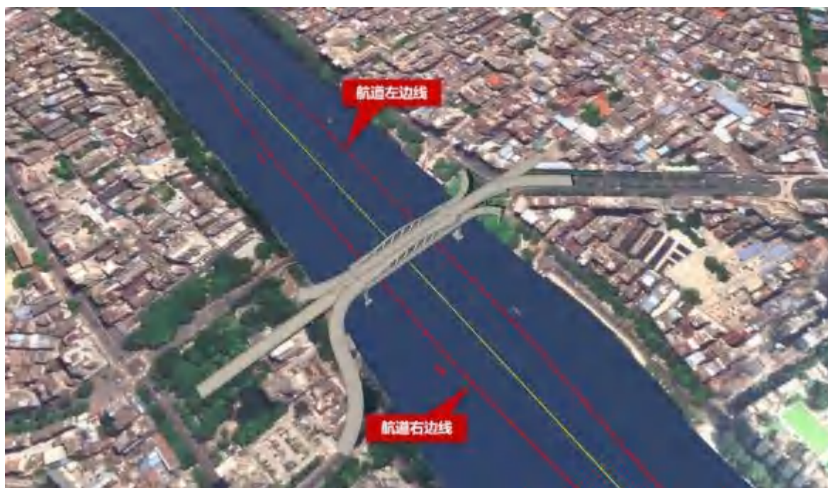
图2.4-3 武江大桥桥区航道线路图
