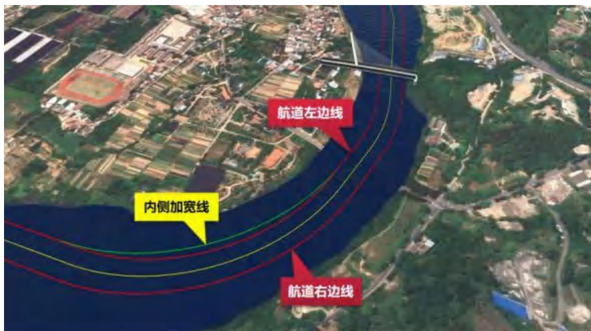
图2.4-6 十里亭大桥桥区航道线路图
