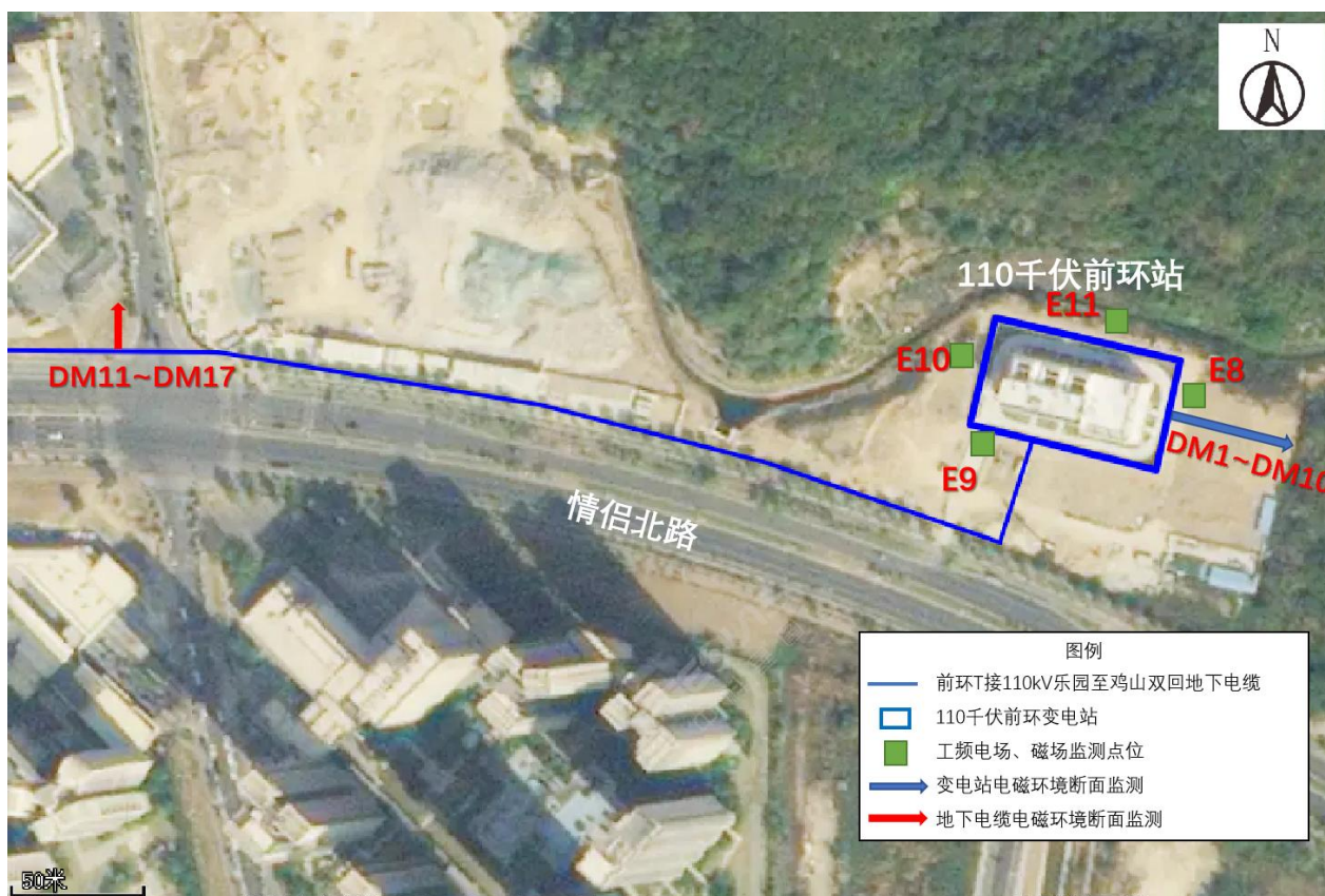
图 1 110 千伏前环变电站监测布点图
