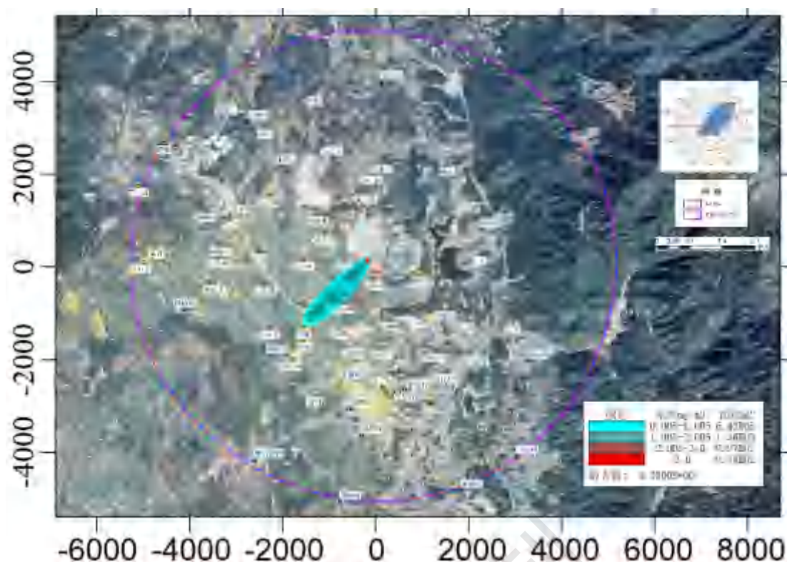
图6.7-14 苯乙烯网格点预测期间（30min）浓度分布图（最常见气象）
