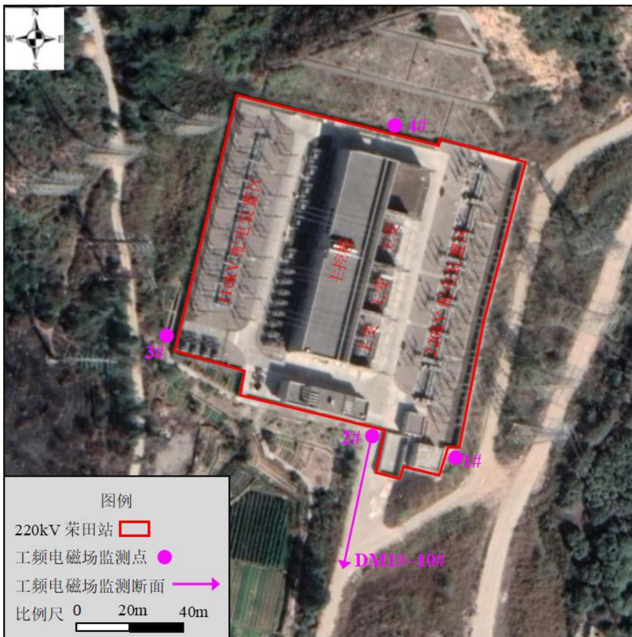
图 8.1-3 惠州 220kV 荣田变电站监测布点图
