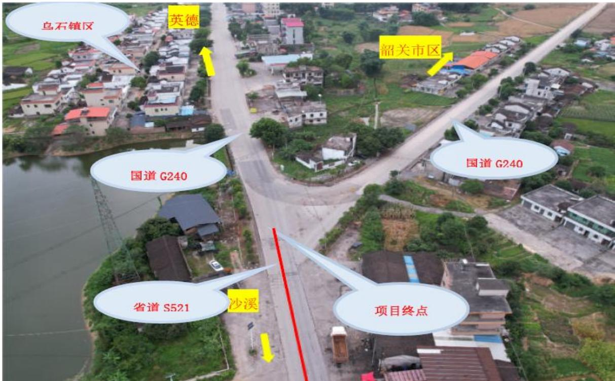
本项目采用二级公路技术标准，设计速度 60km/h（局部路段限速 40km/h），路基宽度 12.0m。在线形设计中，在不显著增加工程量的前提下，宜采用较高的设计指标，使得线形平顺、流畅、连续，指标均衡，与周边自然环境协调，同时应兼顾经济、合理、和工程的易操作性。
