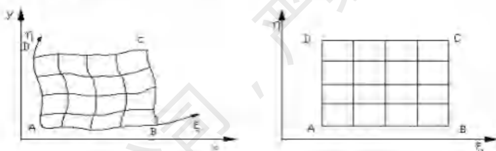
图 6-9 贴体正交曲线网格坐标变换
