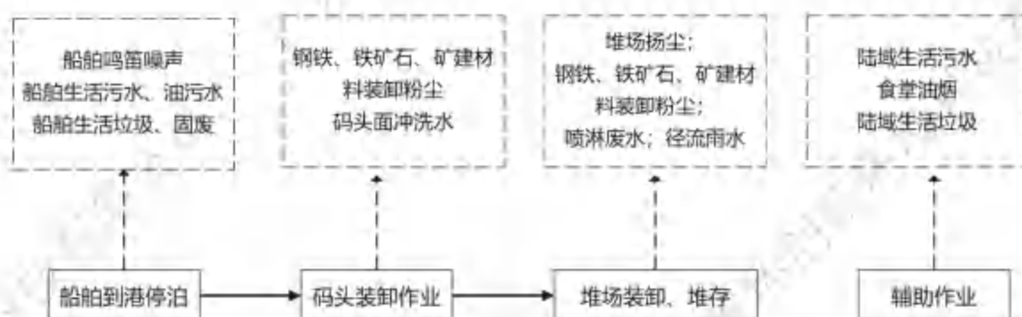
图 3.3-2 本项目运营工艺流程图
