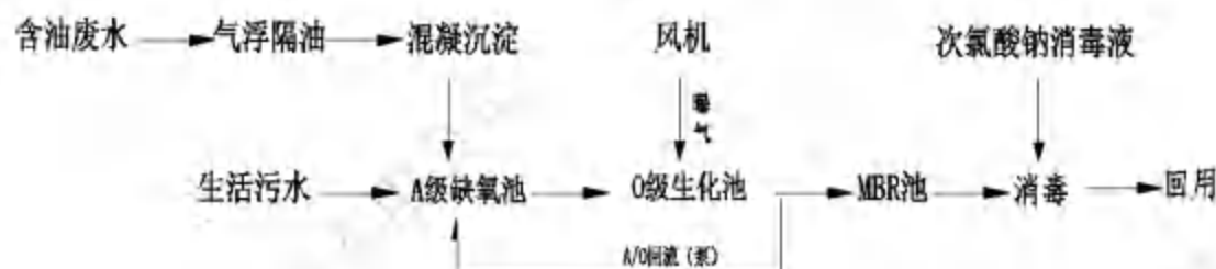
图 7.2-1 生活污水和含油废水处理工艺流程图
