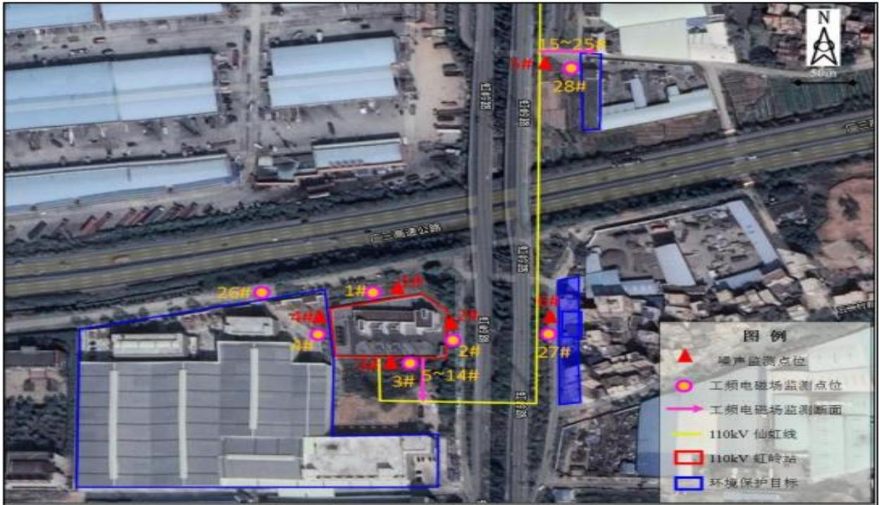
图 2 佛山 110kV 虹岭输变电工程监测布点图
