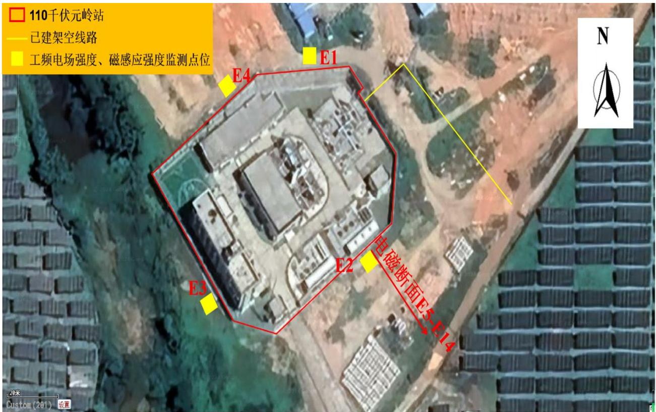
图 1 110kV 元岭站监测布点图
