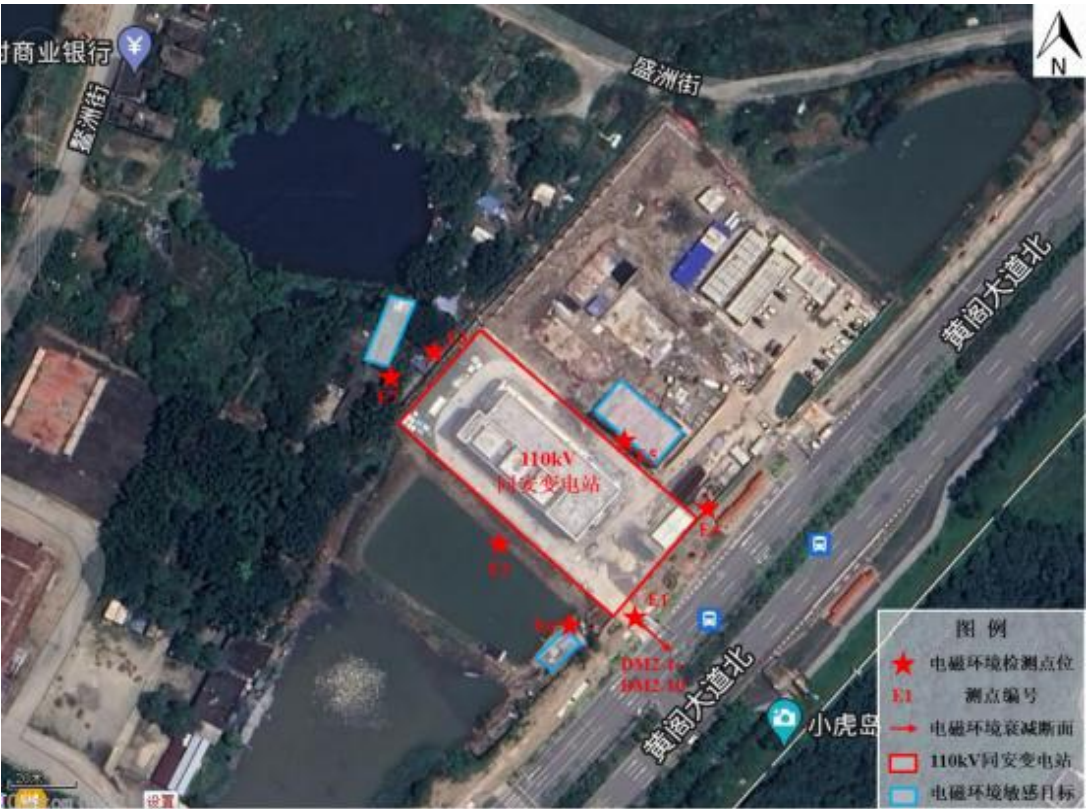
图 1 110kV 同安变电站类比监测布点图
