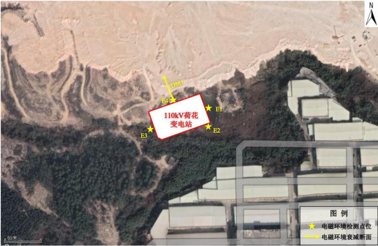
图 1 110kV 荷花变电站类比监测布点图
