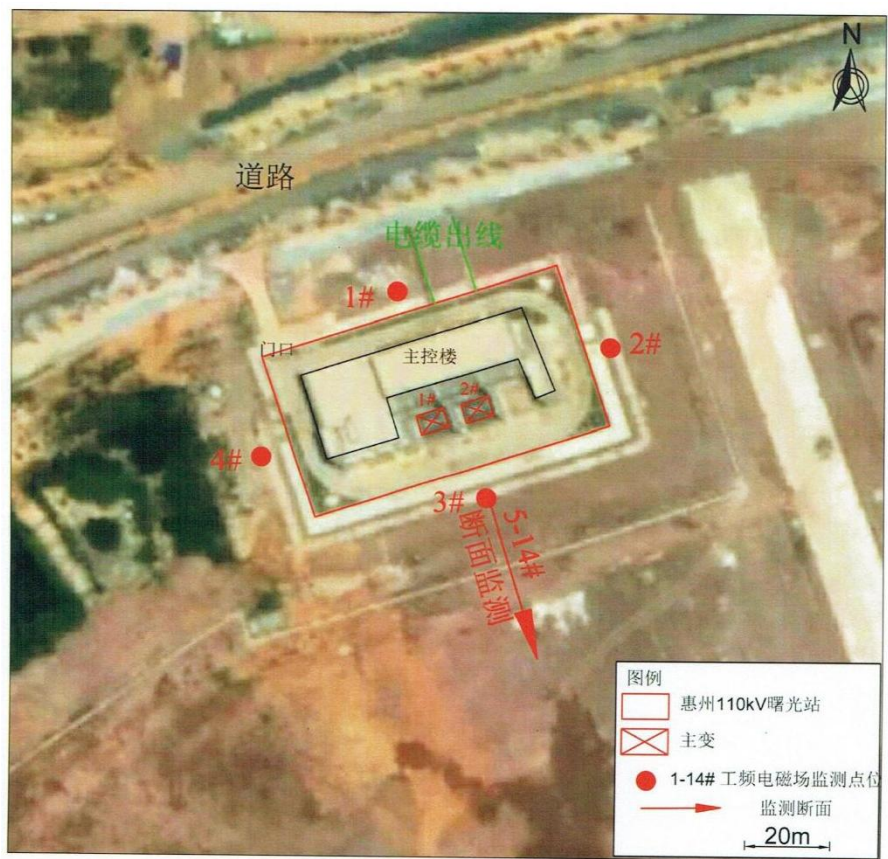
图 8.1-3 惠州 110 千伏曙光变电站监测布点图
