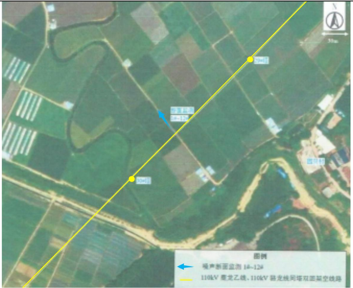
图 4.2-1 类比工程电缆噪声断面监测布点图
