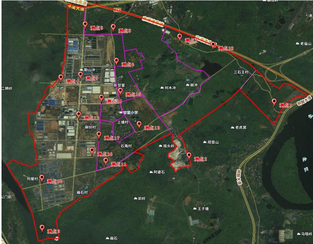
图 3-2 韶关市甘棠工业园土壤电阻率测点位置图
