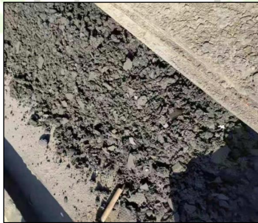
图 3.4-1 喷淋塔沉渣形态实物图
