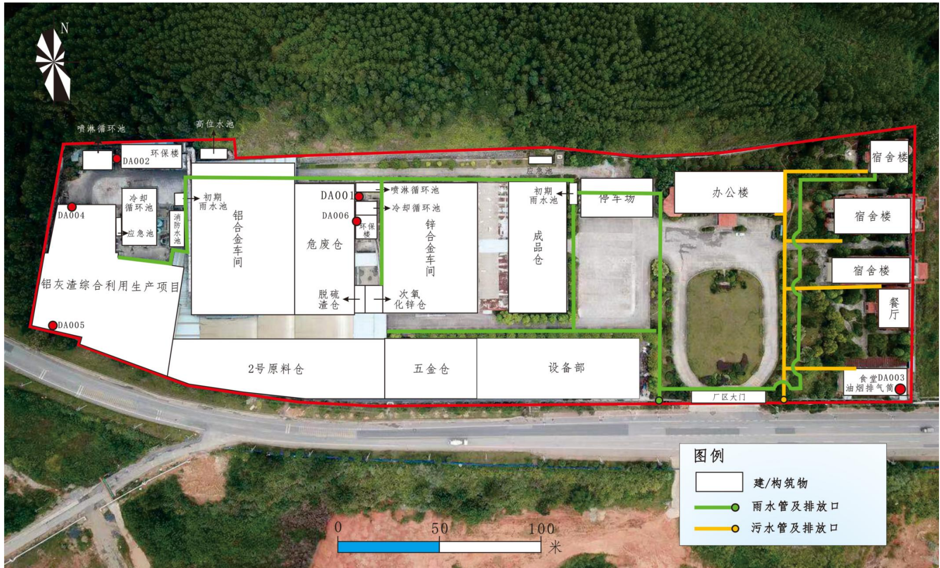
图 3.2-2 现有已建工程厂区雨污管网图
