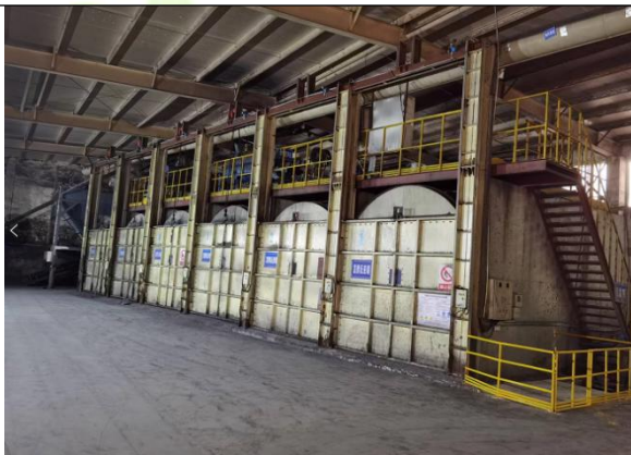
铝灰渣综合利用-发酵反应室
