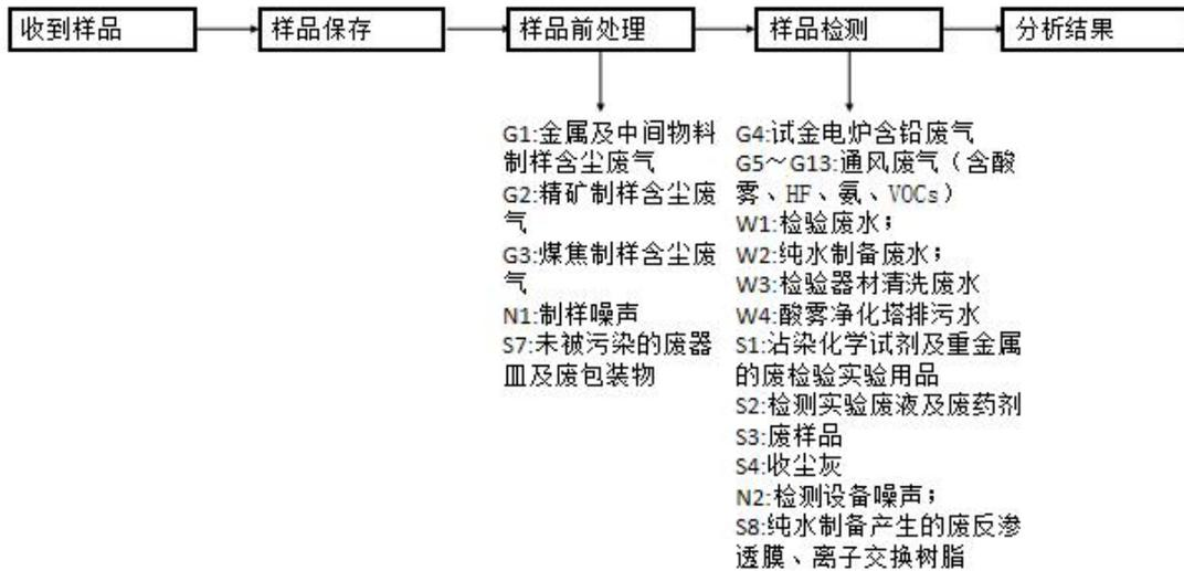
图 3 检验检测工艺流程图
