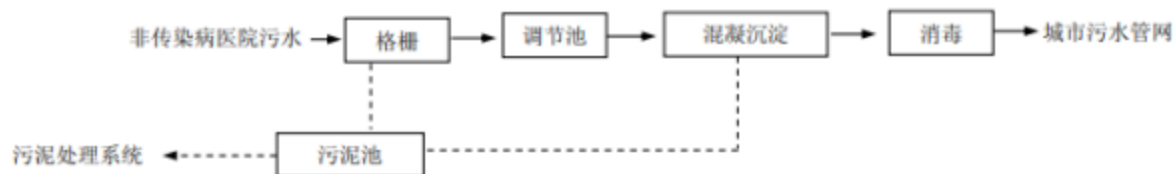
图 6 非传染病医院污水一级强化处理工艺流程
