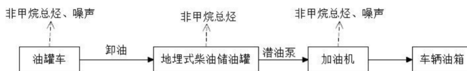
图2-2b 罐车卸油及柴油加油工艺流程及产污环节图
