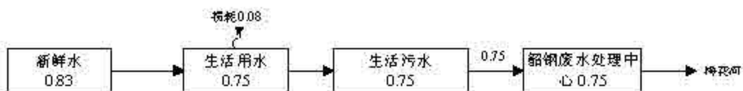
图 1 扩建项目水平衡图 单位: m 3 /d
