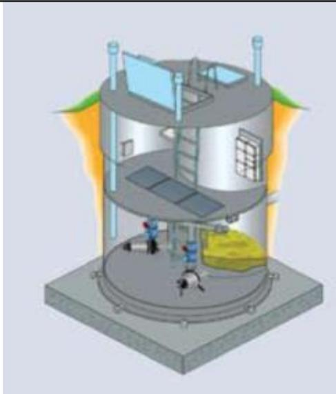
图 2 一体化预制泵站示意图
