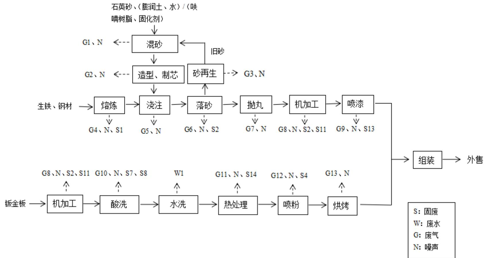
图 2-2 项目生处理产工艺流程及产污节点图
