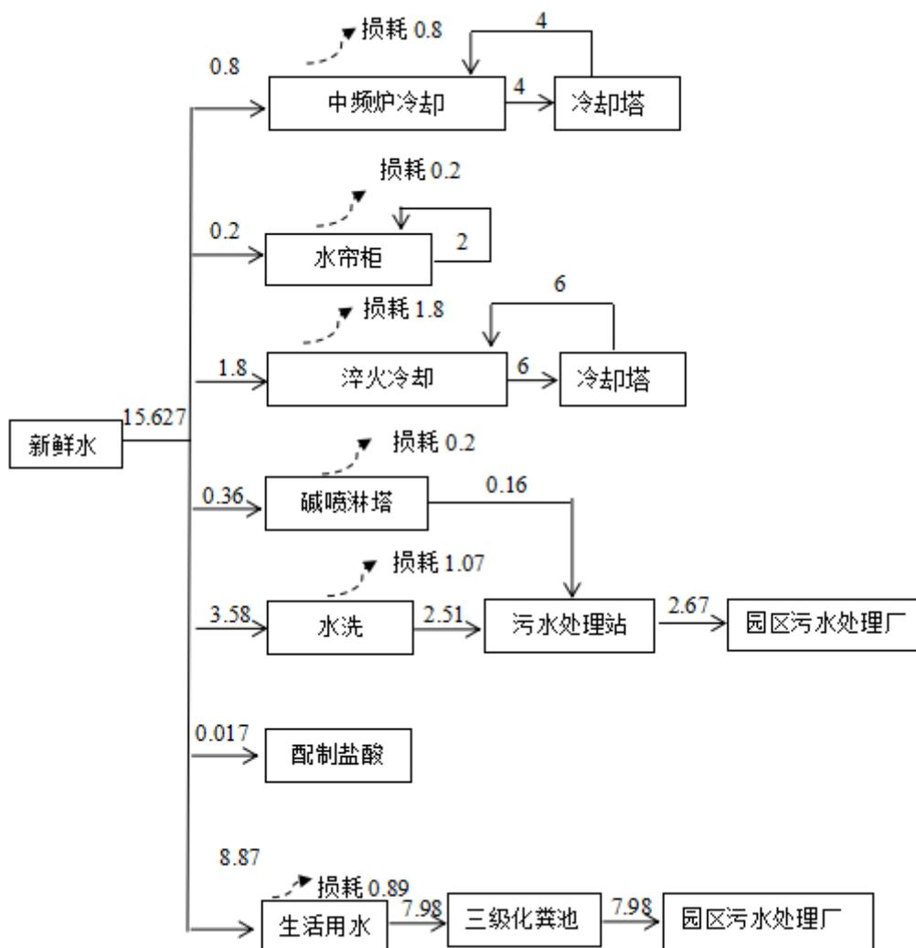
图 2-1 项目水平衡图 m³/d
