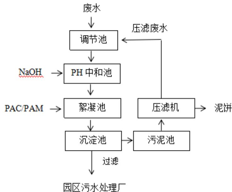
图 4-1 污水处理站工艺流程
