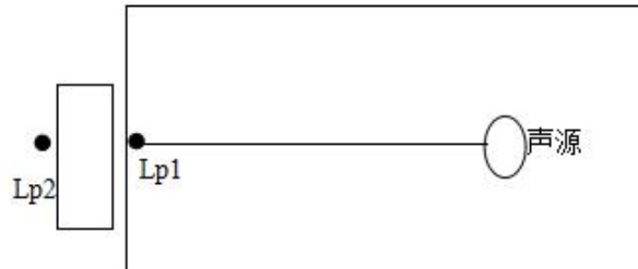
图 4-3 室内声源等效为室外声源图例
