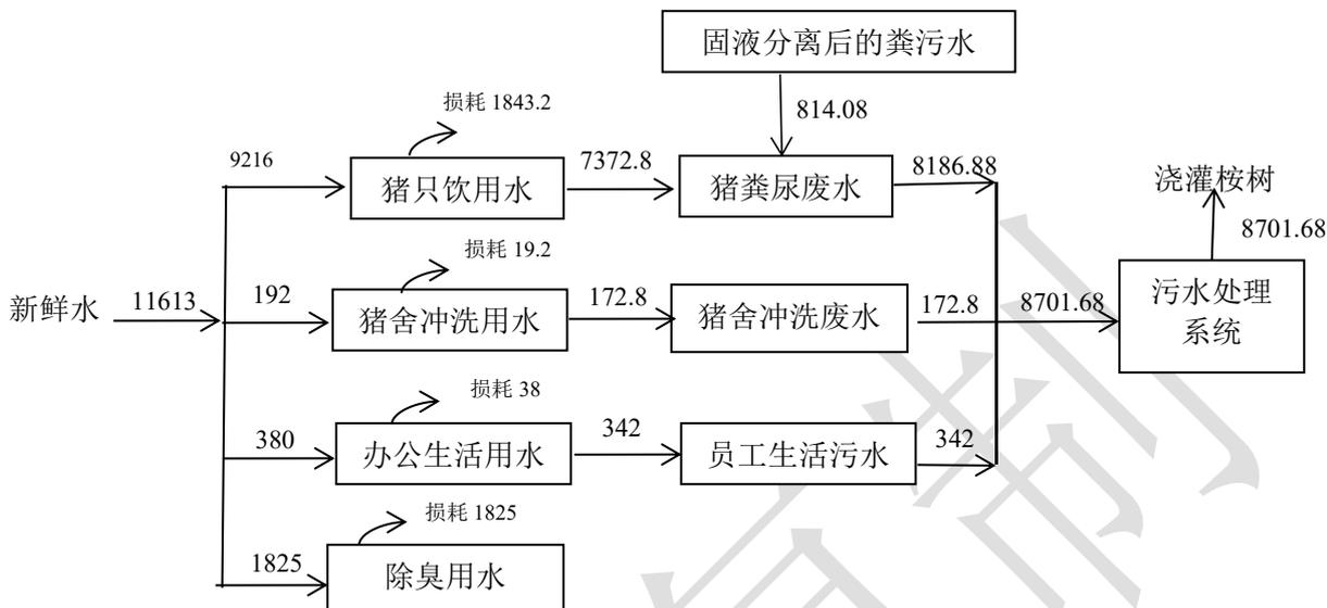
图 3-6 水平衡图 (单位:  $\text{m}^3/\text{a}$ )
