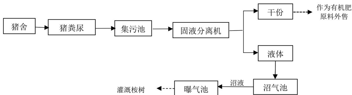
图 3-4 清粪及粪污处理工艺流程图
