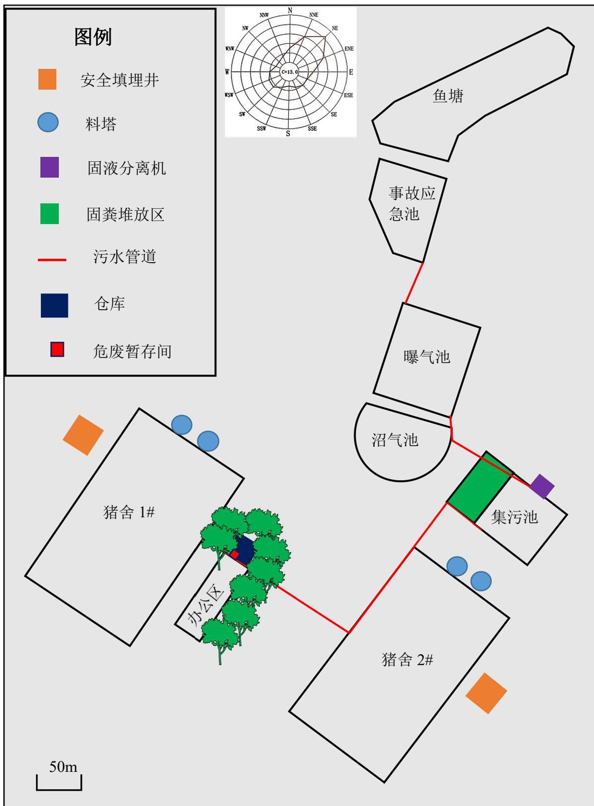
图 3-2 项目平面布置及雨污管网图
