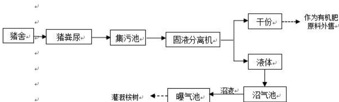
图 7-1 废水处理工艺流程图
