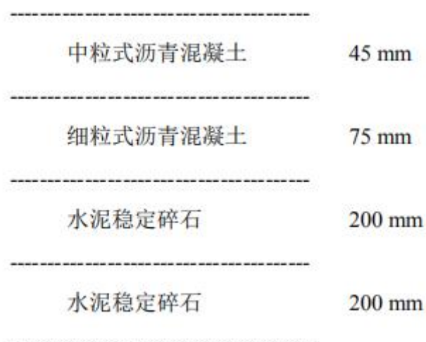
图 2-2 路面横截面结构图
