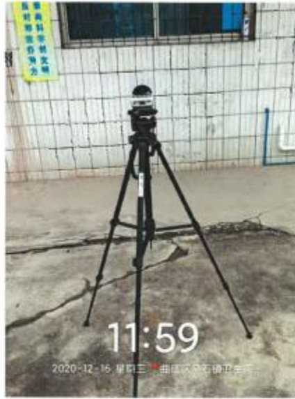
噪声现场检测图
